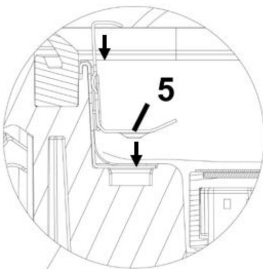
Включите прибор. Откройте крышку прибора, положите открытый конец пакета на сварную планку и зафиксируйте ее. Для этого поднимите фиксатор (5), положите под него конец пакета и прижмите фиксатор вниз.
