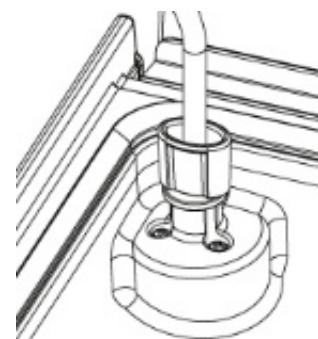
Снимите воздушный фильтр над местом подключения для вакуумного шланга и установите адаптер. Поместите блюда в вакуумный контейнер. Установите крышку контейнера и подсоедините шланг для вакуумирования к крышке контейнера, соедините шланг с помощью адаптера с местом подключения к вакуумной камере прибора.
